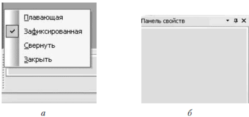
Рис. 1.6. Изменение расположения панели свойств: при горизонтальном (а) и при вертикальном (б) положениях
