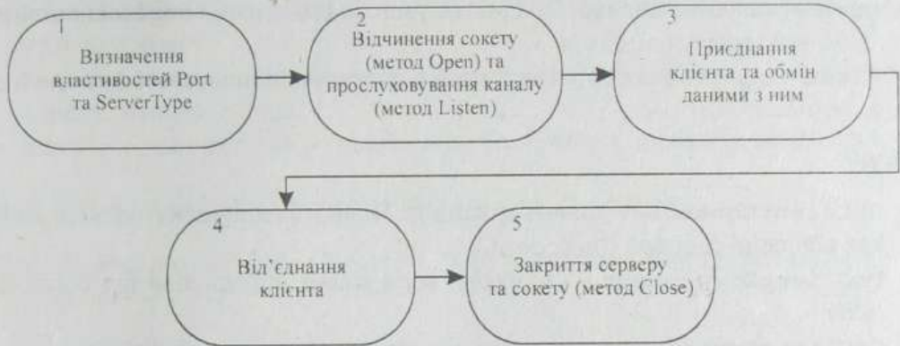
Рис. 5.2. Схема роботи сокетного серверу в Delphi-програмах
