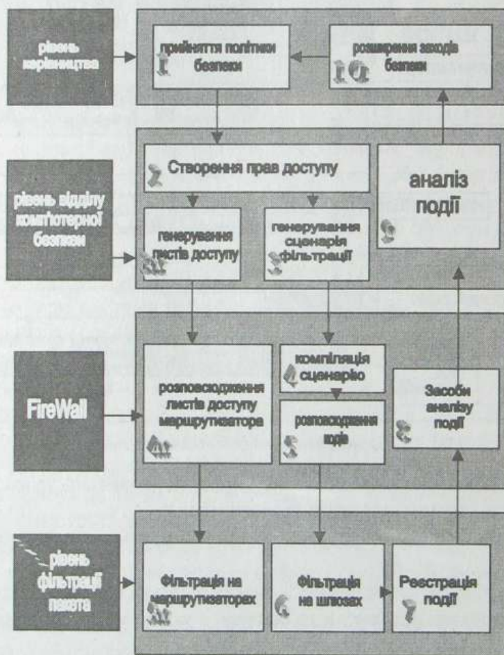
Рис. 11.3. Реалізація політики безпеки організації за допомогою Solstice FireWall-1
