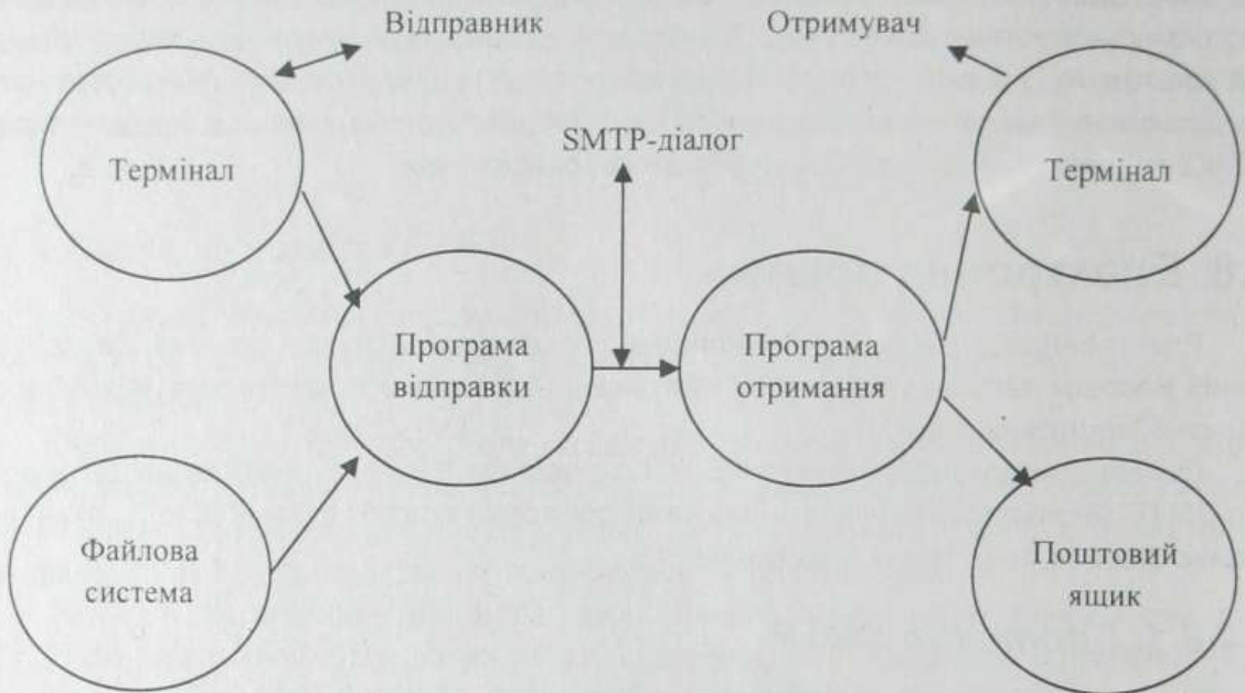
Рис. 4.8. Блок-схема інформаційної взаємодії по протоколу SMTP
