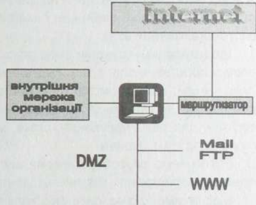
Рис. 11.4. Схема шлюзу Internet
