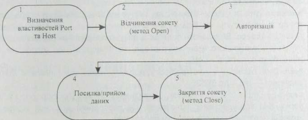
Рис. 5.3. Схема роботи клієнтського серверу в Delphi-програмах
