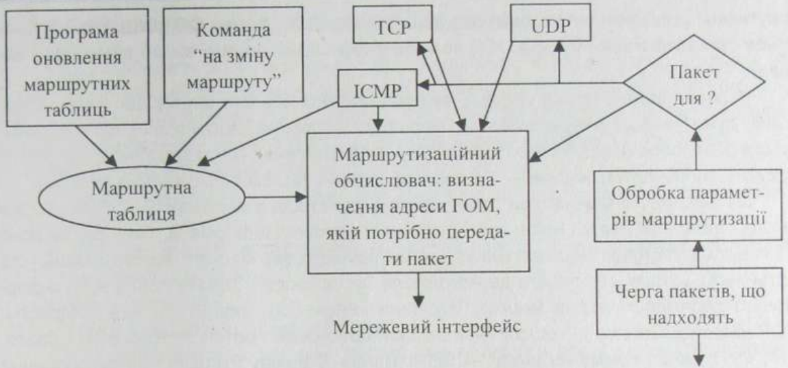
Рис. 4.4. Блок-схема алгоритму маршрутизації пакетів у вузлі IP
