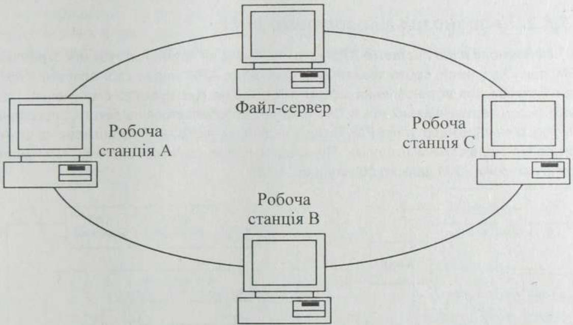
Рис. 1.24. Топологія мережі "кільце"
