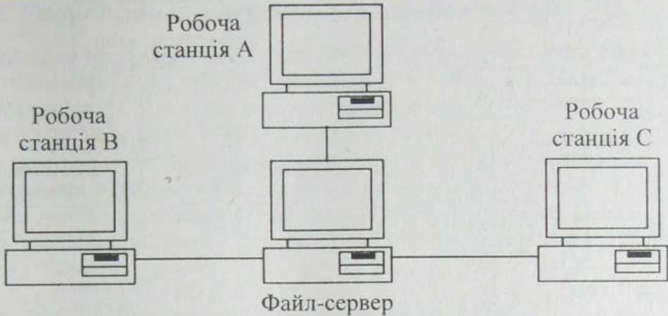
Рис. 1.23. Топологія мережі "зівка"
