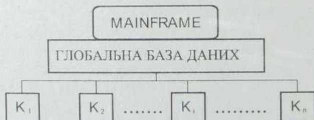
Рис. 1.1. Централізована обробка даних: K — користувач ( i = 1, 2, \dots, n )
