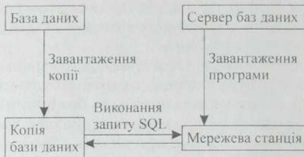
Рис. 1.33. Класична архітектура обміну даними в мережі
