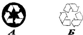
Рис. 6.7 Знаки, що вказують на можливість перероблення матеріалу виробу або містять вторинний матеріал: А – продукт придатний для повторного перероблення, Б – продукт містить перероблені матеріали
