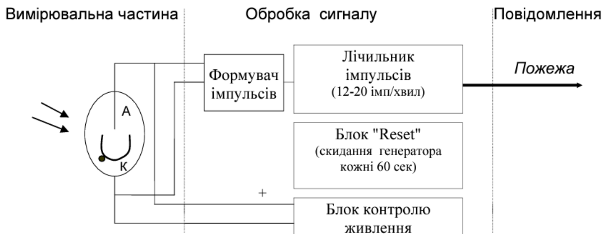
Рис. 4.3 - Структурна схема сповіщувача полум'я УФ типу
