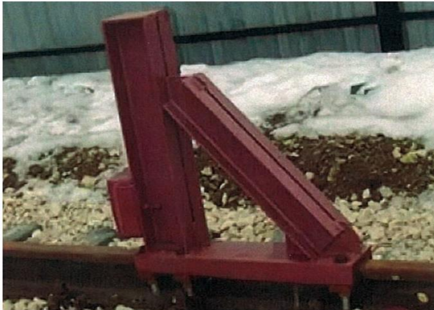
Рисунок 3.3 – Тупиковий упор ударного типу [6]
