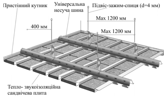
Рис. 5. Конструктивна схема підвісної тепло-звукоізоляційної стелі
