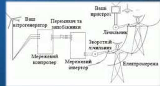
Рис. 2 – Схема роботи вітрогенератора паралельно підключеного з роботою мережі без акумуляторних батарей
