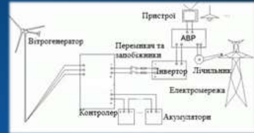
Рис. 2 – Схема роботи вітрогенератора паралельно підключеного з роботою мережі
