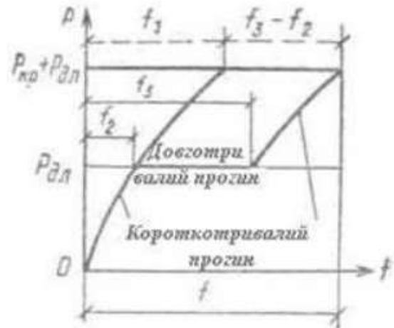
Рис. 10.14. До розрахунку прогинів попередньо напружених елементів.
