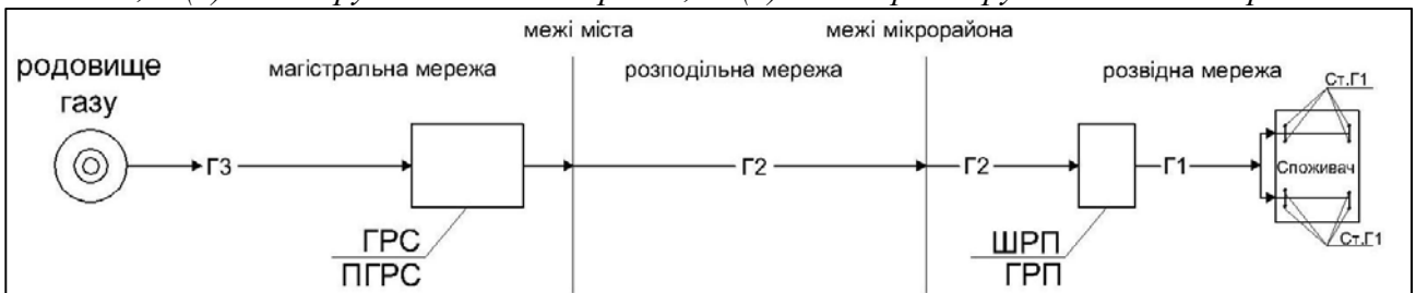
Рисунок 2.4 – Принципова схема газової мережі:
