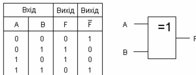
Рисунок 3.5 – Елемент “Виключаюче АБО” і його таблиця функціонування
