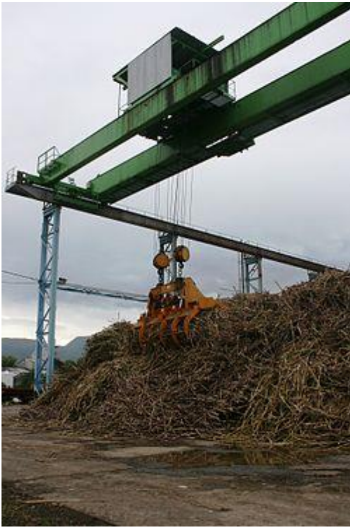
Кран двобалковий опорний грейферний з кабіною
