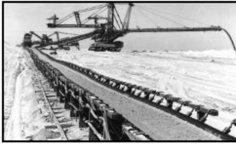
Стрічковий конвеєр з відвалоутворювачем на кар'єрі.
