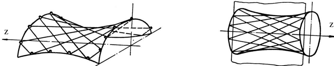
Рисунок 5.15 – Схеми армування необолонкових конструкцій
