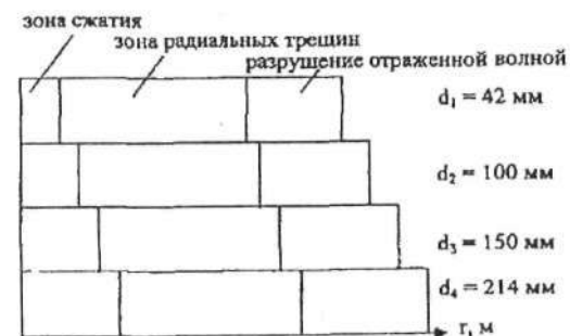
Малюнок 8.3.1. - Діаграма зон руйнування для різних діаметрів заряду
