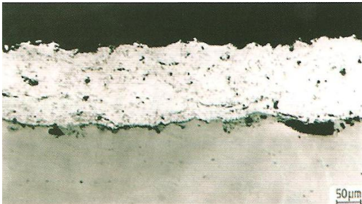
Рис. 2.5. Цинк-алюмінієве покриття металоконструкцій
