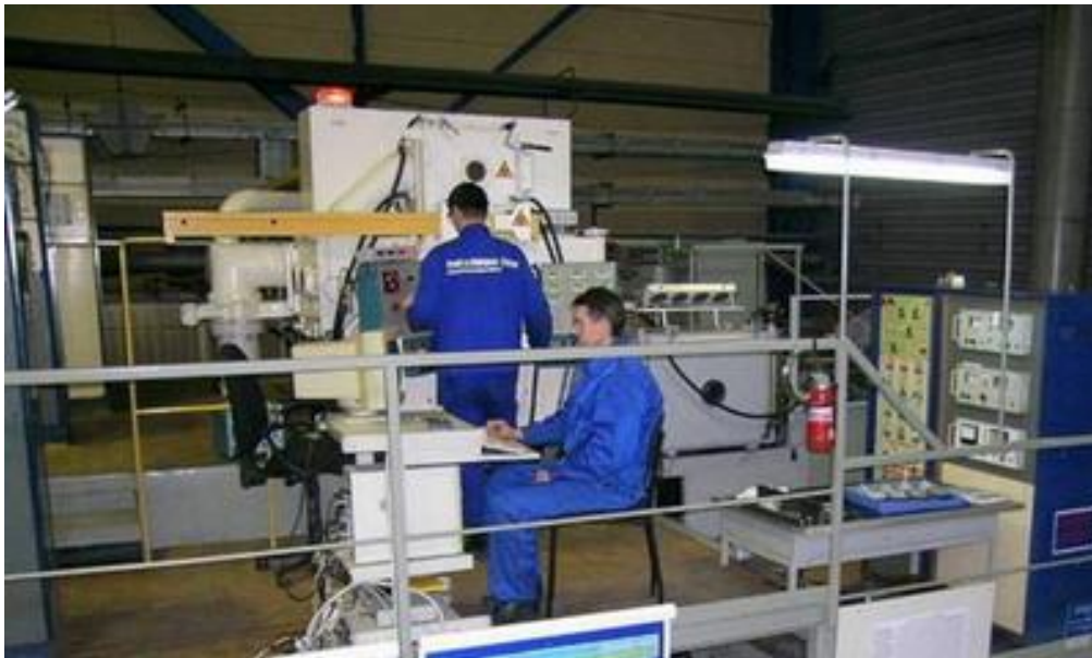
Рис. 2.10. Електронно-променева установка UE-193 для нанесення металевих жаростійких і корозійностійких захисних покриттів на лопатки турбін осадженням з парової фази у вакуумі
