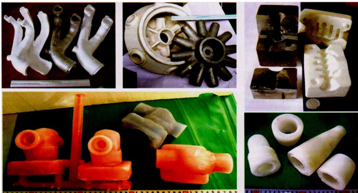
Рис. 1.5. Приклади разових моделей і виливків з каналами складної форми (для з'ясування розмірів на фото показані лінійки та копійка)
