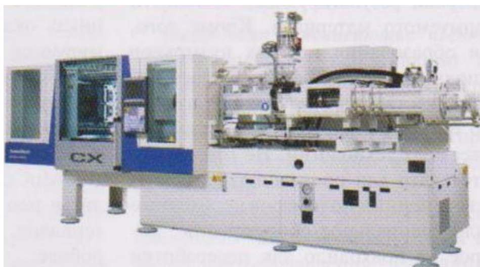
Рис. 1.1. Устаткування для реалізації процесу MuCell
