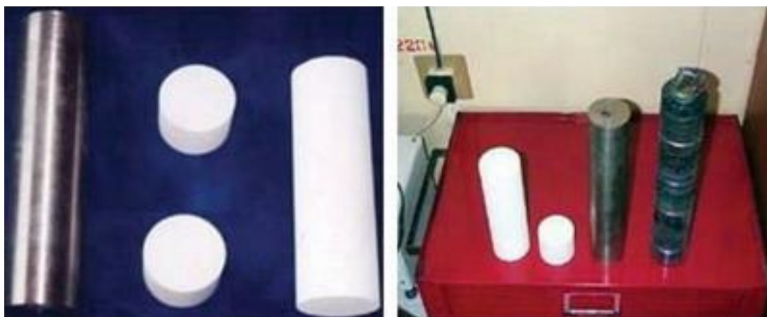
Рис. 2.12. Зливки жаростійких сплавів MeCrAlY і зливки частково стабілізованого діокисню цирконію
