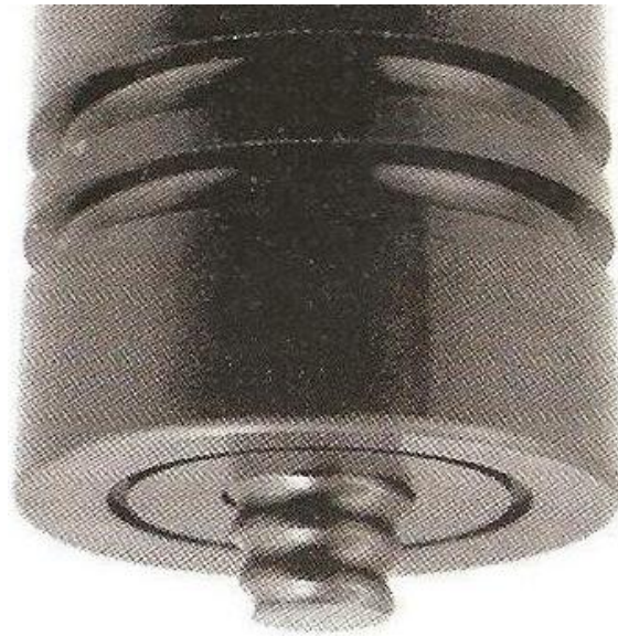
Рис. 1.26. Робочий інструмент для зварювання сталевих труб тертям з перемішуванням
