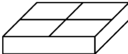
Рис. 3.5. Розмітка зразка перед прокаткою
