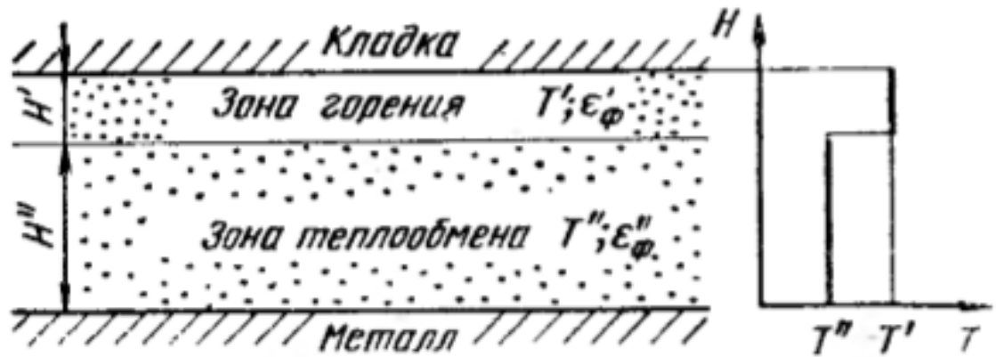
Рисунок 2.1 - Схема теплообміну в печі з плоскополум'яними пальниками
