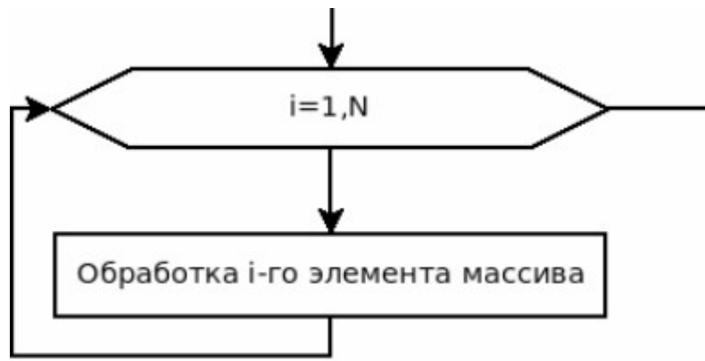
Рисунок 5.5: Блок-схема обработки элементов массива с использованием цикла for
