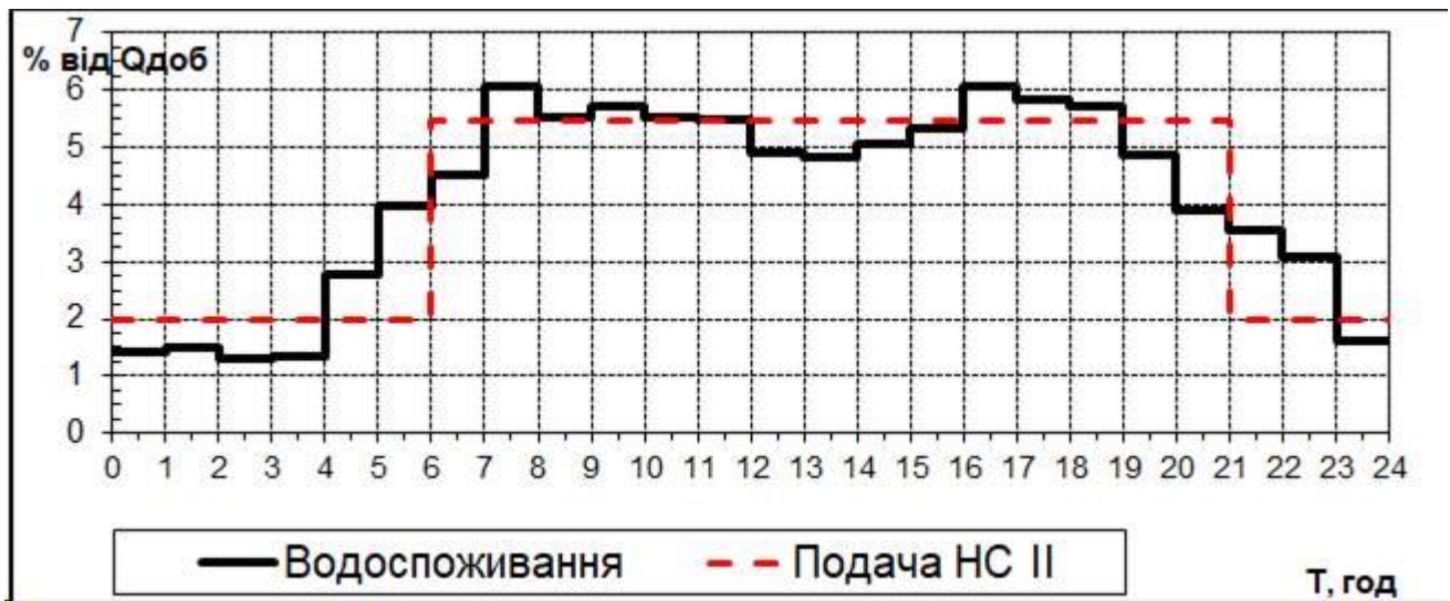
Рисунок 5.1.1 – Графік роботи насосної станції та водоспоживання міста
