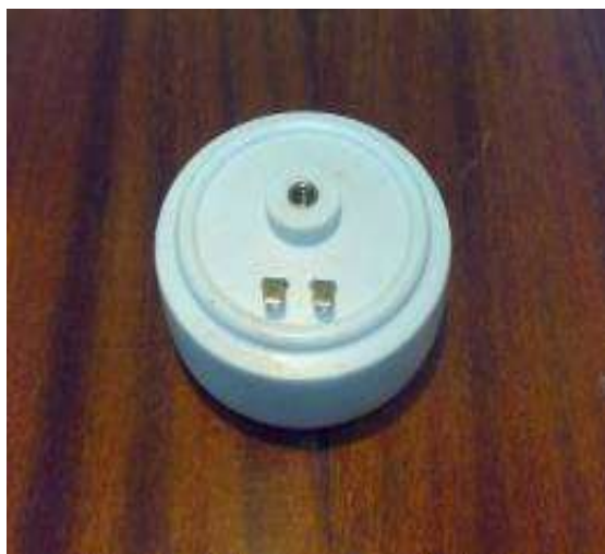
Рис. 3.3. Перетворювач електромагнітного типу електричного сигналу звукового діапазону у механічні коливання “РІАС -2ЕМ”
