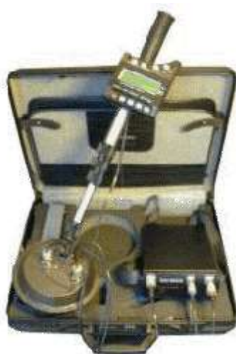
Рис. 3.12. Нелінійний локатор фірми "Энвис" NR-900EM, виробництва РФ
