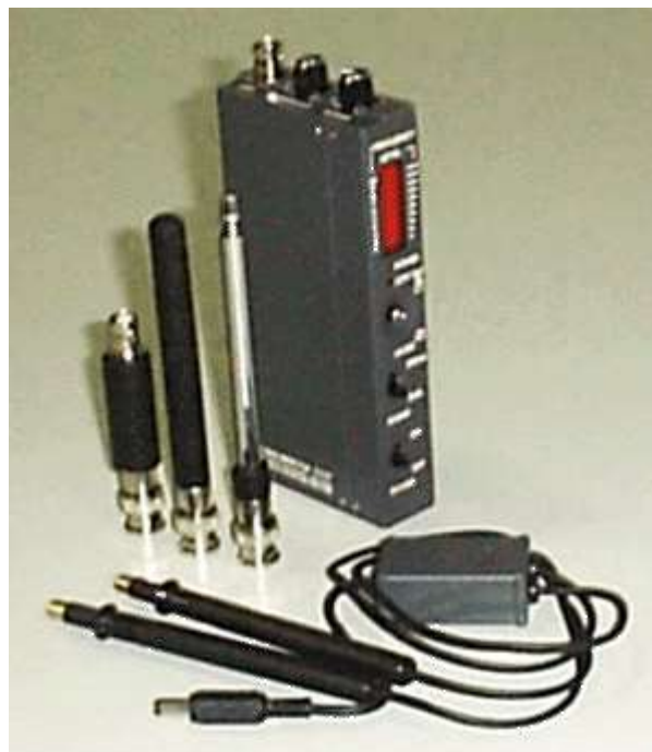
Рис. 3.9. Індикатор-частотомір електромагнітного випромінювання для пошуку у ближньому полі фірми “Optoelectronics”
