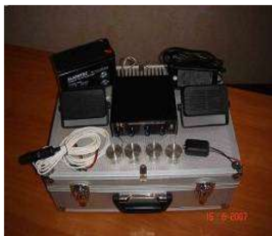
Рис. 3.2. Генератор РІАС-2М. Генератор розміщено у кейсі разом з комплектом випромінювачів та з'єднуючих шнурів для підключення. На фото генератор разом з комплектом розміщено на кришці кейса
