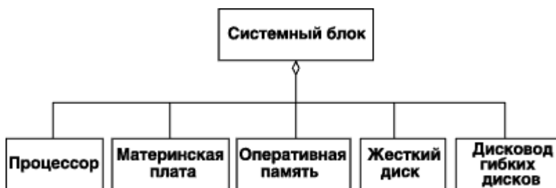
Рис. 3-2.10. Диаграмма классов для иллюстрации отношения агрегации на примере системного блока ПК
