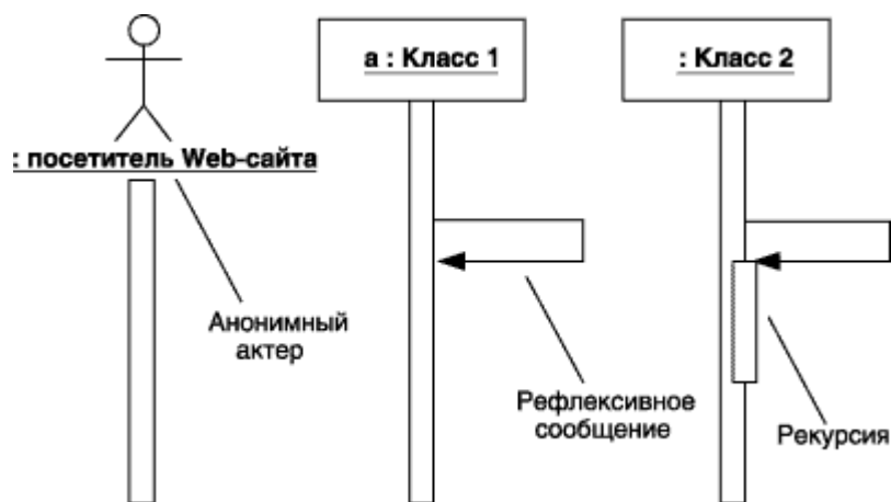
Рис. 3-4.3. Графическое изображение актера, рефлексивного сообщения и рекурсии на диаграмме последовательности
