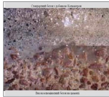
Зразок сучасного зміцнення просочуванням бетону за допомогою Кальматрон
