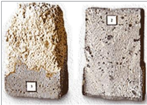
Звичайний бетон Бетон зміцнений добавкою Кальматрон
