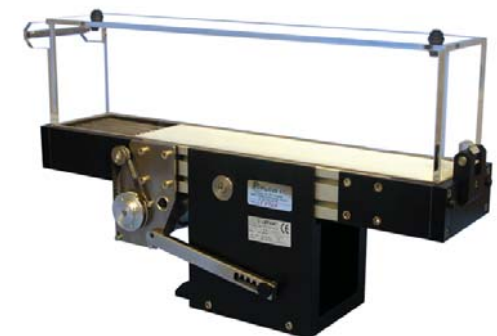
Рис. 49. Тредмил для оценки развития усталости в ходе динамических нагрузок
