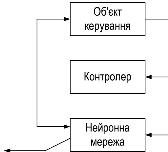
Рис. 2.30. Нейромережна система керування, заснована на „копіюванні” існуючого контролера
