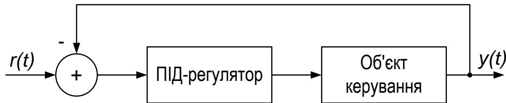
Рис. 2.11. Структура системи із застосуванням ПІД-регулятора
