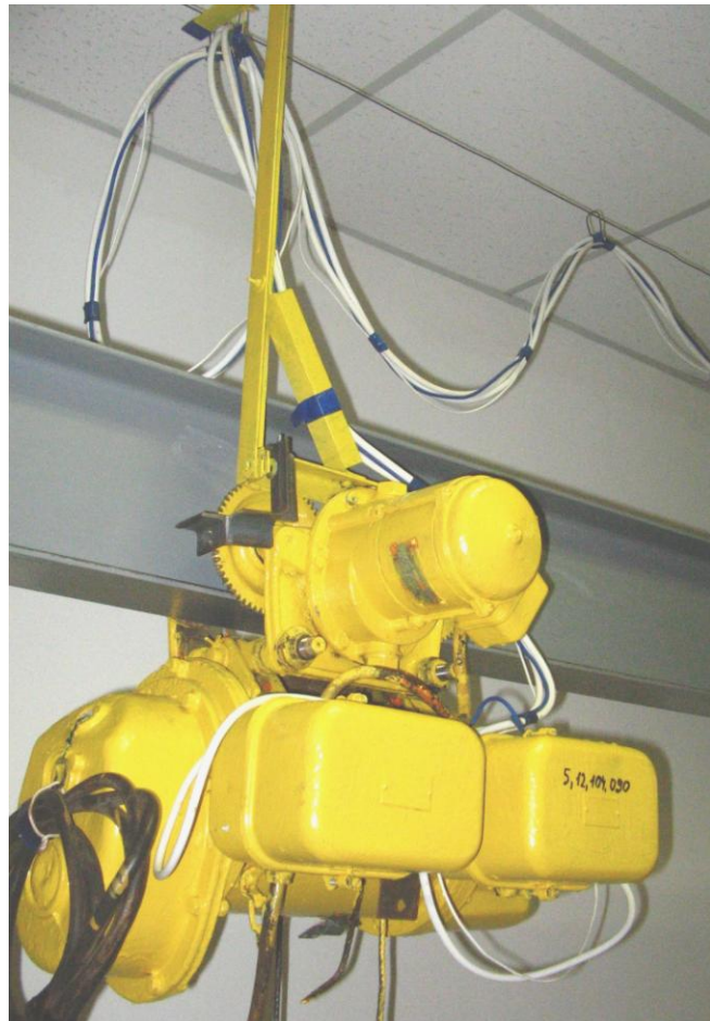
Рис. 4. Зовнішній вигляд моделі візка (електроталь): а) модель візка з вантажем; б) модель вантажного візка.
