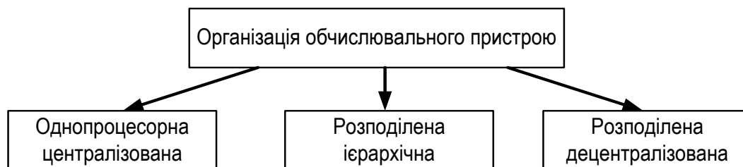
Рис. 3.1. Способи організації обчислювального пристрою системи комп'ютерного керування
