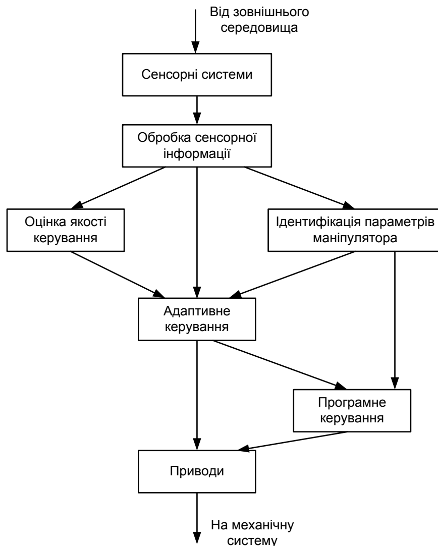
Рис. 4.16. Схема адаптивного керування маніпулятором
