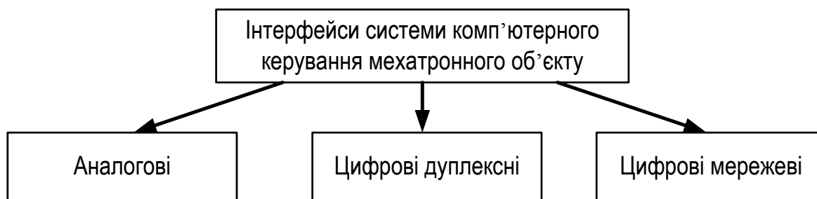
Рис. 3.9. Типи інтерфейсів системи комп'ютерного керування мехатронного об'єкта
