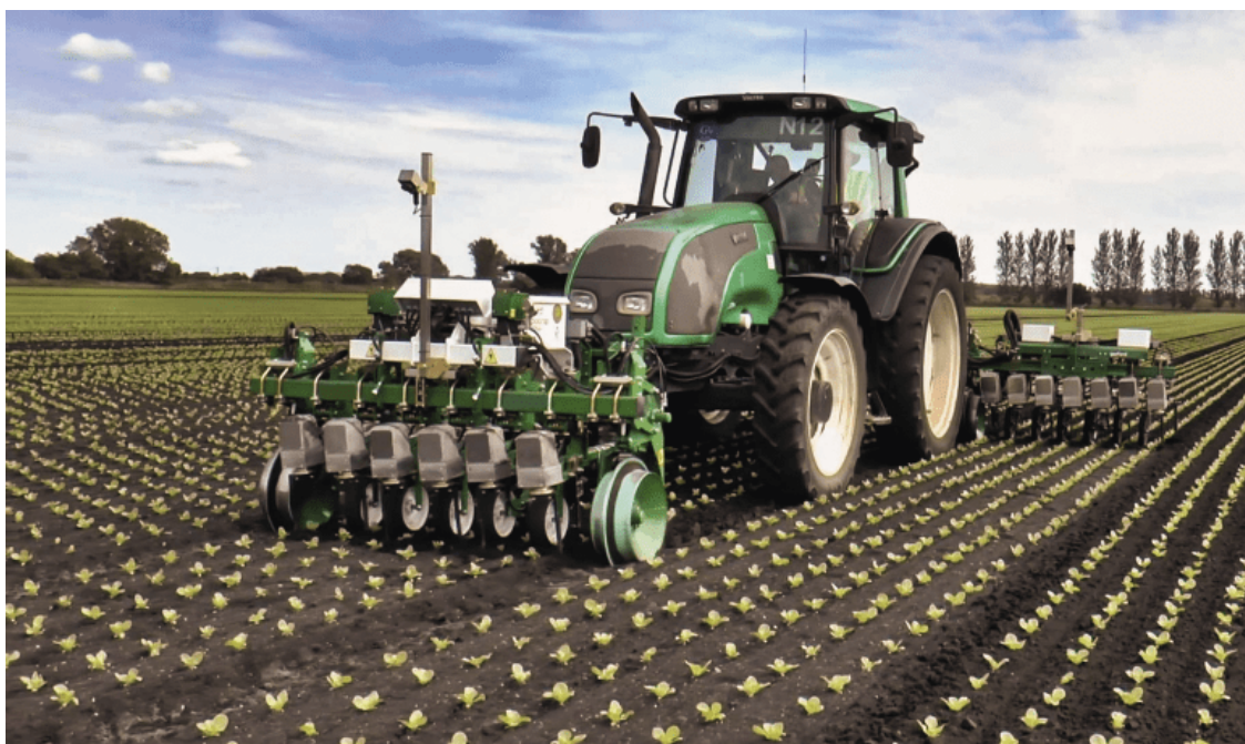
Рисунок 3.44 – Водіння машини без участі оператора при міжрядній обробці просапних культур
