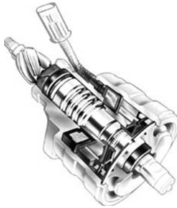
Рисунок 2.34 – Виконавчий механізм системи Magnasteer [7]
