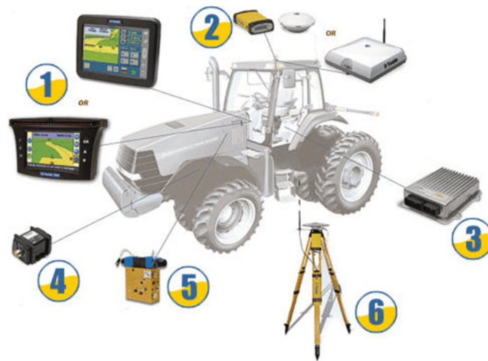
1 – дисплей курсопоказчика AgGPS; 2 – антена приймача GPS GLONASS; 3 – контролер; 4 – датчик повороту; 5 – гідроклапан; 6 – RTK базова станція
