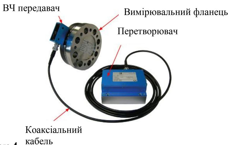
Рисунок 4. Комплект датчика крутного момента TF
