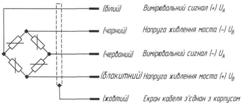
Рисунок 4.4 Вимірювання зусиль натягу в канатах механізму підйому електродугової печі
