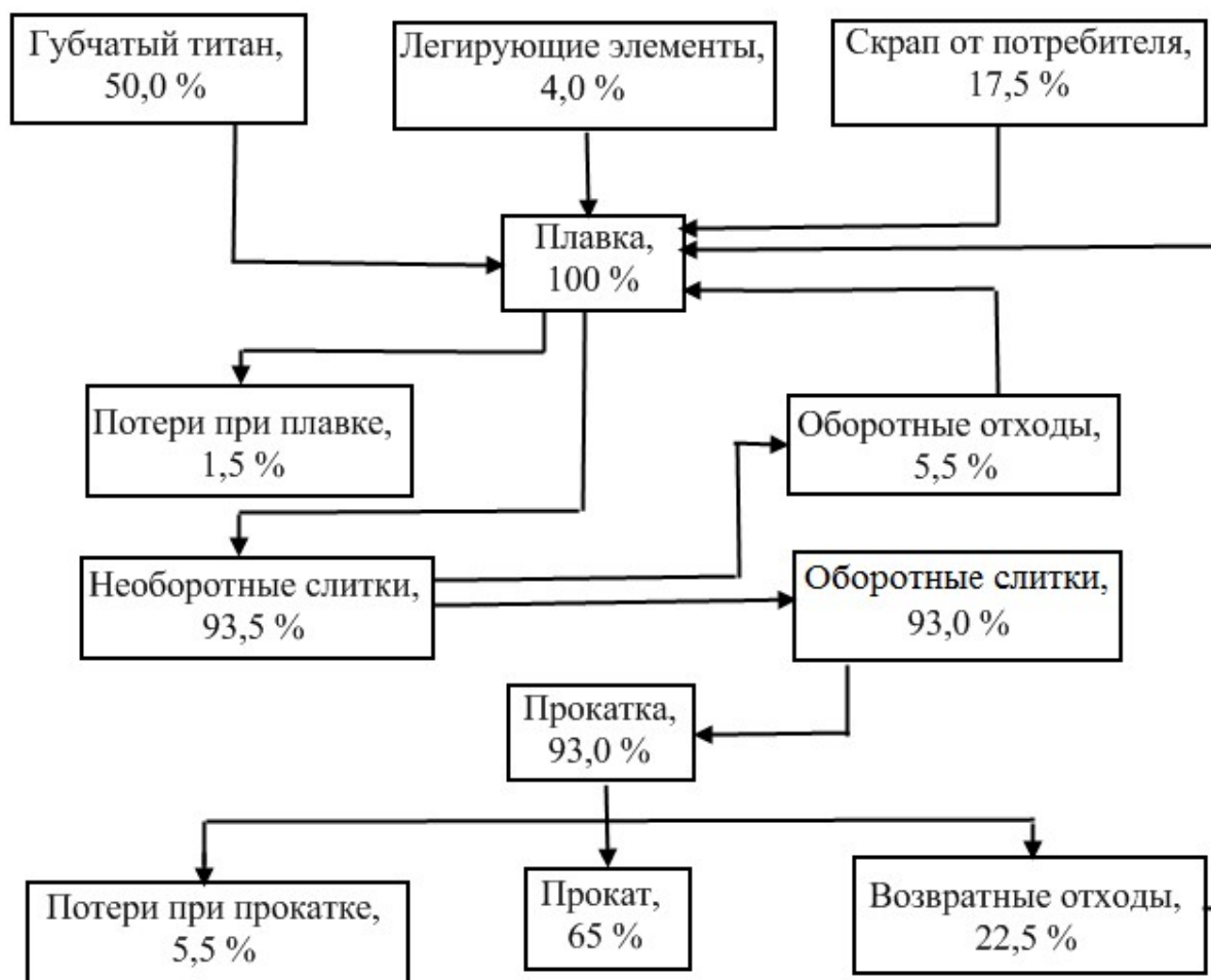
Рисунок 3 – Схема перспективного технологического процесса выплавки и проката титана на крупном металлургическом заводе [19]
