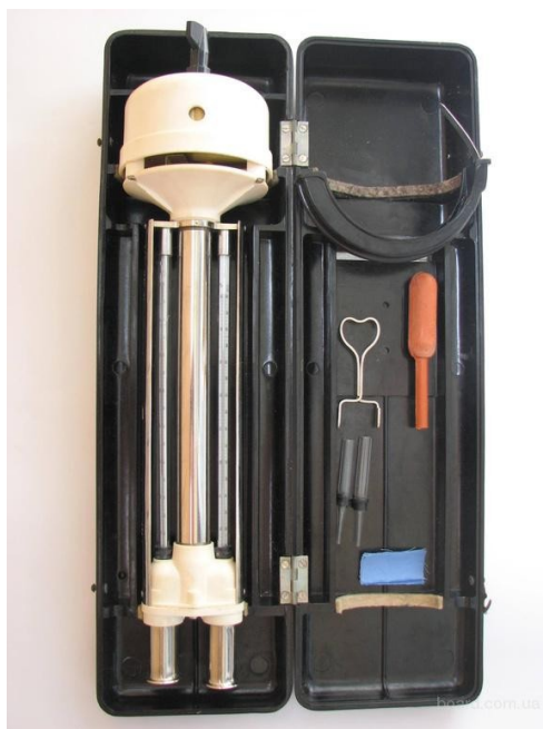
Рис. 5.2. Психрометр аспіраційний МВ-4М: зліва – загальний вигляд, справа – будова; 1 – гумова груша; 2 – затискач; 3 – піпетка; 4 – повітрозахист; 5 – крючок-підвіс; 6 – ключ, 7 – віконце; 8 – головка аспіратора; 9 – трубка; 10, 11 – “сухий” та “змочений” термометри; 12 – захисні планки; 13 – трійник;
