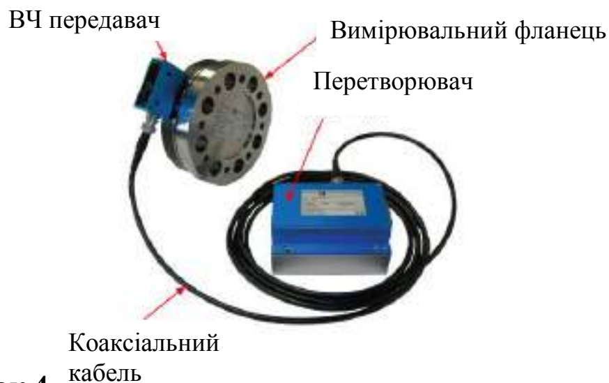
Рисунок 4. Комплект датчика крутного моменту TF
