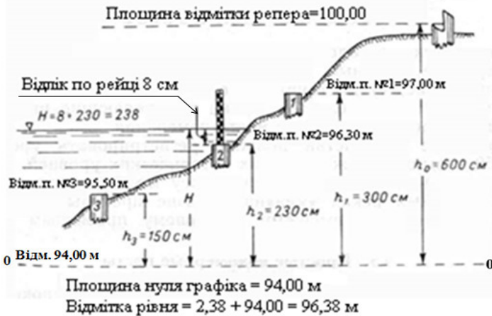
Рис. 2.12. Схема відміток і відліків на палевому гідрологічному посту
