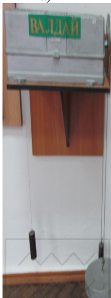
Рис. 2.7. Самописець «Валдай»: а) загальний вигляд; б) кінематична схема; в) розріз; 1 – груз; 2 – поплавок; 3 – протизвага; 4 і 5 – поплавкове колесо; 6 – шестерня; 7 – годинниковий механізм; 8 – барабан; 9 – ролик; 10 – каретка; 11 – струна; 12 – направляючі стержні; 13 – ролик; 14 – груз; 15 – перо; 16 – барабан; 17 – шестерня; 18 – трос; в) схема включення масштабних шестерінок з барабаном; 19 – штифт; 20 – зубчасте колесо-трибка; 21 – вісь редуктора; 22 – вісь з'єднана з барабаном; 23 – шестерня, закріплена на осі 22; 24 – шайба; 25 – підкладки; 26 – головка рушійної осі
