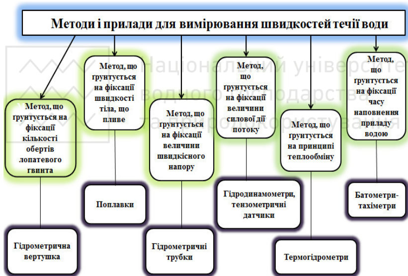
Рис. 4.4. Методи і прилади для вимірювання швидкостей течії води (при гідрометричних роботах)
