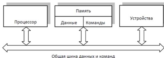
Рис. 2.1. Архитектура с общей шиной данных и команд
