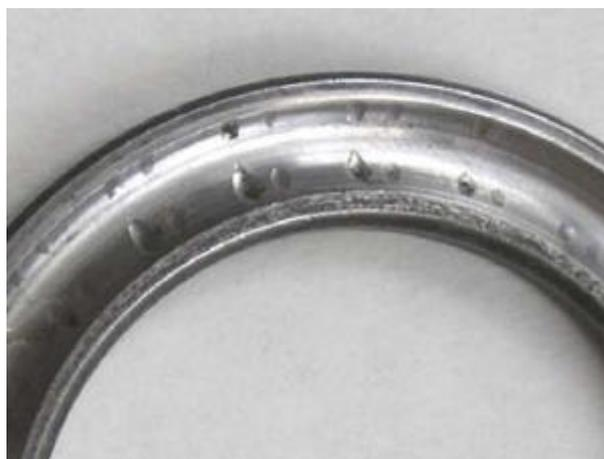
Рисунок 7.15 — Бринеллирование на беговых дорожках упорного шарикоподшипника — вмятины с шагом, равным шагу тел качения
