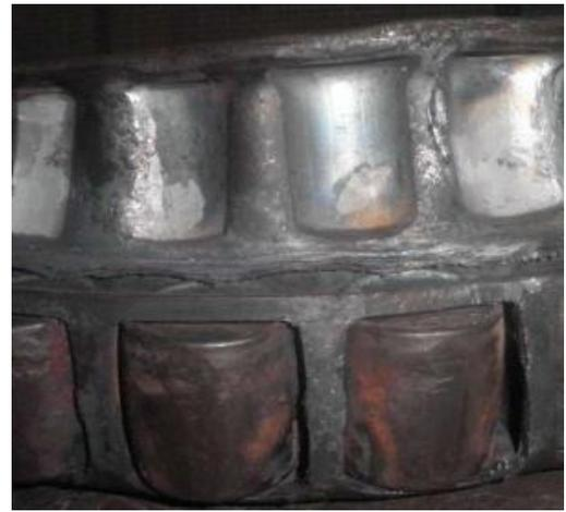
Рисунок 9.4 — Повреждения радиально-упорного шарикоподшипника из-за недостатка смазочного материала:
