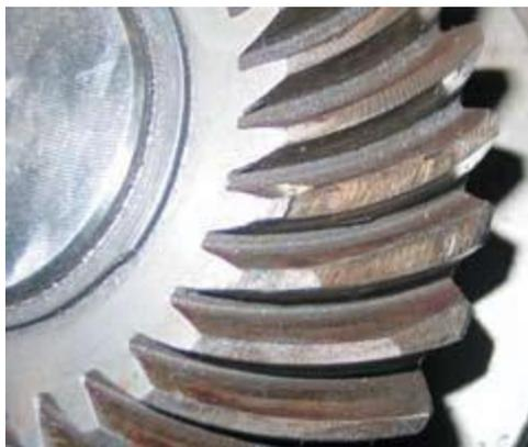
Рисунок 7.34 — Повреждения конического колеса при выходе зубьев из зацепления
