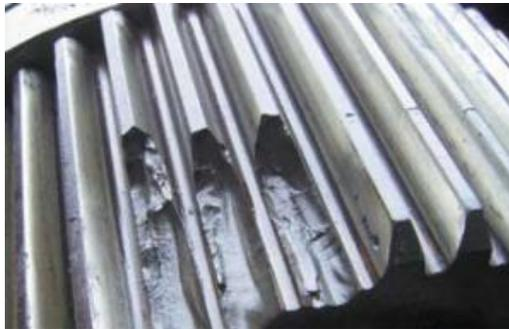
Рисунок 7.21 — Излом зубьев из-за воздействия динамических ударов
