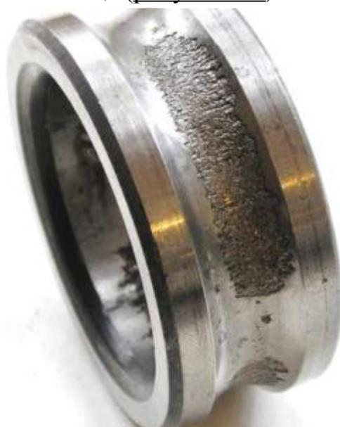
*Рисунок 7.4 — Местное выкрашивание внутреннего кольца шарикоподшипника при вращающейся радиальной силе, неподвижном наружном кольце и одновременном воздействии осевой силы*
