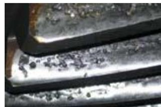
Рисунок 7.19 — Превышение предела выносливости материала приводит к осповидному выкрашиванию рабочей поверхности:
