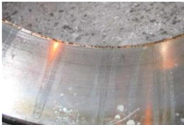
Рисунок 7.16 — Следы ложного бринеллирования на рабочей поверхности наружного кольца роликового радиально-упорного конического однорядного подшипника
