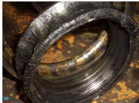
Рисунок 9.5 — Повреждения радиально-упорного шарикоподшипника из-за недостатка смазочного материала
