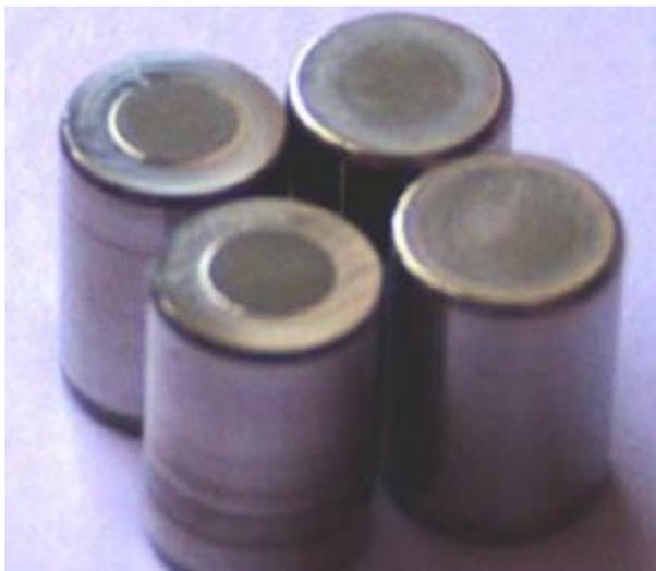
*Рисунок 7.5 — Высветления на торцах роликов одной из беговых дорожек двухрядного радиального роликоподшипника при воздействии осевой силы*
