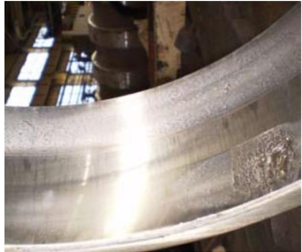
Рисунок 7.1 — Следы радиальной силы, постоянной по направлению:
