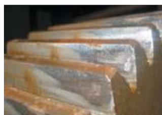
*Рисунок 7.31 — Сокращение пятна контакта из-за непараллельного расположения осей зацепления при уменьшенном расстоянии между осями зубчатых колёс*
