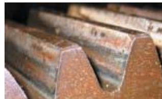
Рисунок 7.18 — Отсутствие деформаций — признак воздействия номинальной нагрузки:
