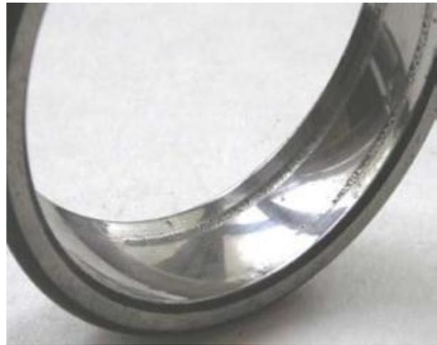
*Рисунок 7.9 — Неравномерное выкрашивание при изгибе вала:*
