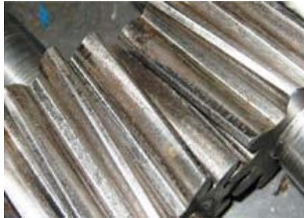
*Рисунок 7.24 — Начальная стадия абразивного износа колеса шестерённого насоса — появление рисок на рабочей поверхности зубьев*
