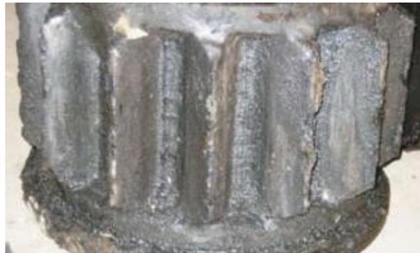
*Рисунок 7.25 — Предельная стадия абразивного износа кремальерной шестерни*
