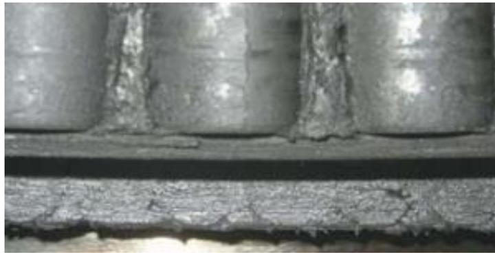
Рисунок 9.1 — Накопление продуктов износа в смазочном материале:
