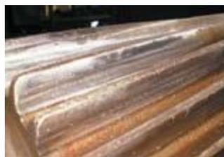
Рисунок 7.33 — Неравномерное распределение действующих сил по длине зуба и равномерное распределение по окружности зубчатого колеса
