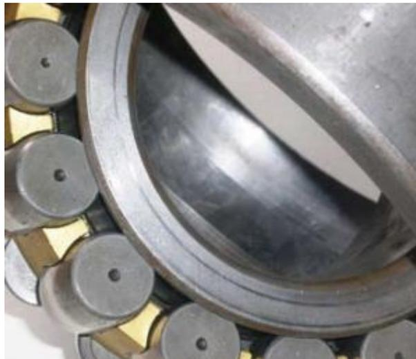
*Рисунок 7.10 — Кольцевые риски на торцевой поверхности внутреннего кольца — результат контакта кольца подшипника с неподвижной деталью*
