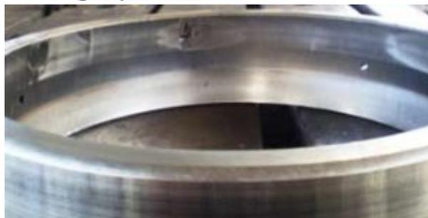
Рисунок 7.2 — Осповидное выкрашивание в двух местах на беговой дорожке наружного кольца двухрядного сферического радиального роликоподшипника при отклонении формы посадочного места крышки подшипника
