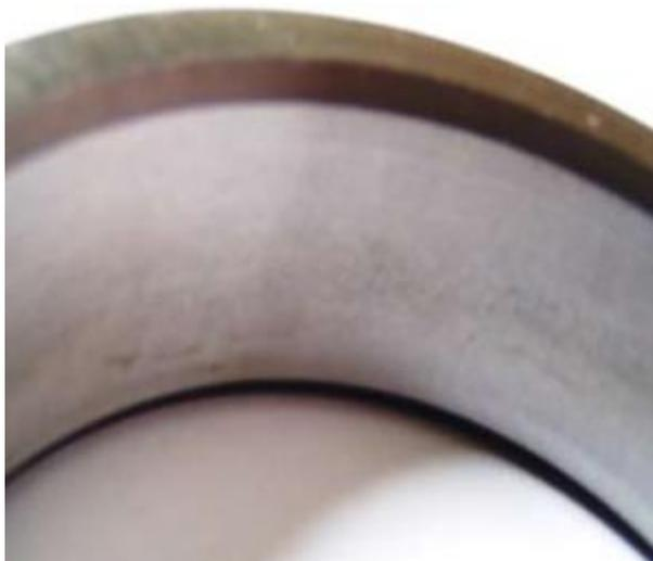
*Рисунок 7.6 — Матовая поверхность внутреннего кольца подшипника при неподвижной посадке на вал*
