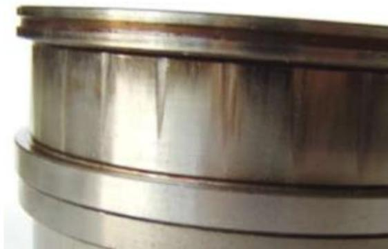
Рисунок 7.11 — Треугольная форма контакта кольца с роликом при перекосе вала относительно корпуса двухрядного роликового радиального подшипника
