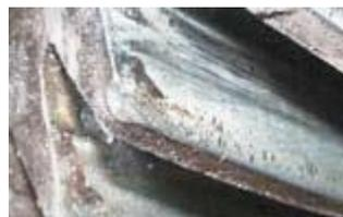
Рисунок 7.20 — Пластические сдвиги на рабочей поверхности зубчатой передачи — напряжения на площадках контактов превысили предел текучести:
