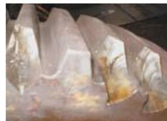
Рисунок 7.35 — Локальные разрушения зубьев из-за реализации усталостных трещин
