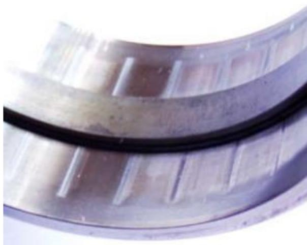
*Рисунок 7.3 — Местное изнашивание беговой дорожки наружного кольца двухрядного радиального роликоподшипника при колебательном движении*
