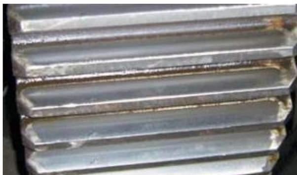
*Рисунок 7.30 — Равномерное расположение пятна контакта по длине и высоте зуба*
