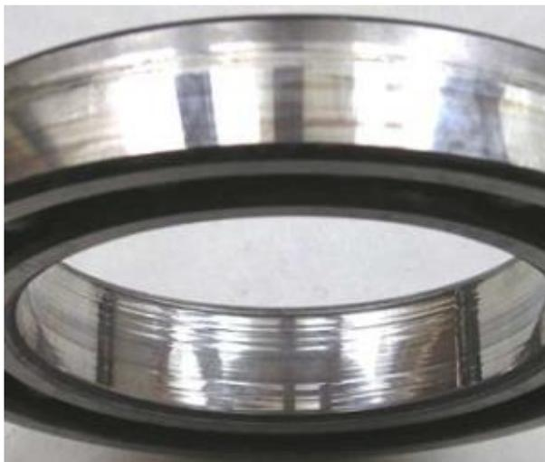
Рисунок 7.7 — Следы проворачивания колец подшипника
