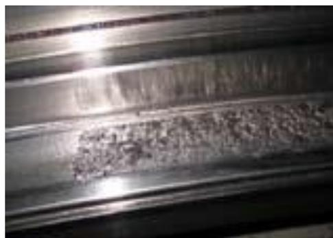
Рисунок 9.2 — Неравномерное смазывание беговых дорожек двухрядных подшипников:
