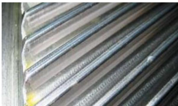
Рисунок 7.27 — Окислительный износ поверхности зубчатой передачи при жидкостном трении
