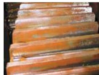
Рисунок 7.23 — Следы коррозии на поверхности зубьев:
