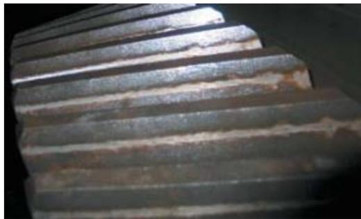
Рисунок 7.22 — Пятно контакта на нерабочей поверхности зуба колеса
