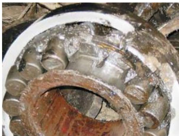
Рисунок 7.17 — Разрушение сепаратора
