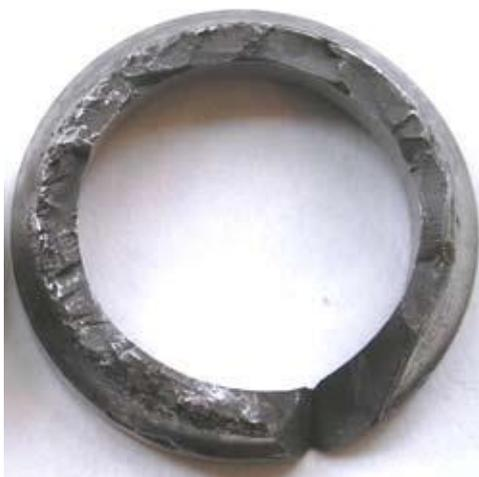
Рисунок 7.13 — Разрушение наружного кольца шарикоподшипника при отсутствии теплового зазора
