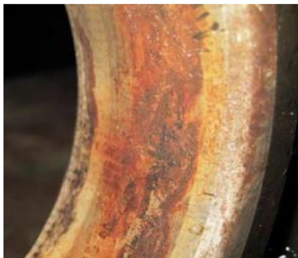
Рисунок 7.8 — Следы фреттинг-коррозии на посадочной поверхности колец шарикоподшипника:
