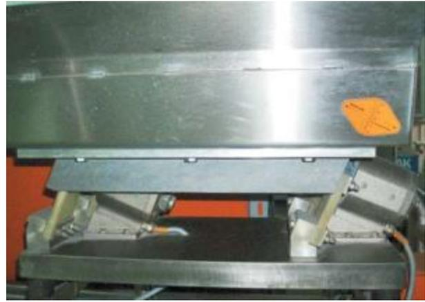
Рисунок 6.3 — Установка мерного клина для измерения амплитуды колебания вибрационного дозатора
