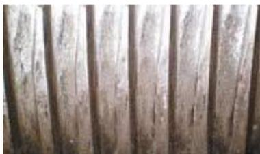
*Рисунок 7.32 — Неравномерный износ зубьев зубчатой муфты при несоосности валов*
