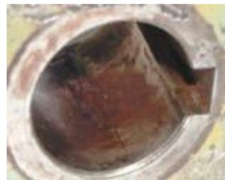
*Рисунок 7.26 — Состояние посадочных поверхностей зубчатого колеса и вала:*
