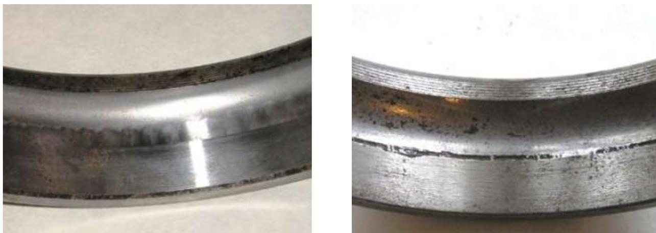
Рисунок 7.14 — Нерабочая часть беговой дорожки радиально-упорного шарикового подшипника при увеличенной осевой игре и продольном нагружении:
