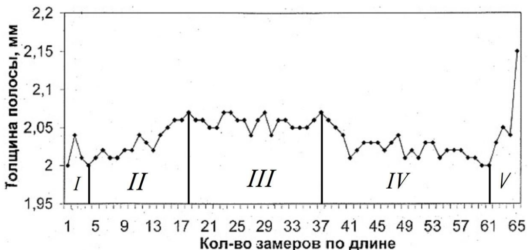
Рисунок 2.5- Зміна товщини штаби 2 \times 1000 мм із сталі марки 1пс, яка прокатана з використанням Coilbox (довжина сляба L = 9,3 м). (Дані меткомбінату «Запоріжсталь»)
