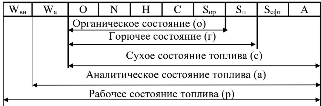
Рисунок 1.1 - Схема состояний топлива
