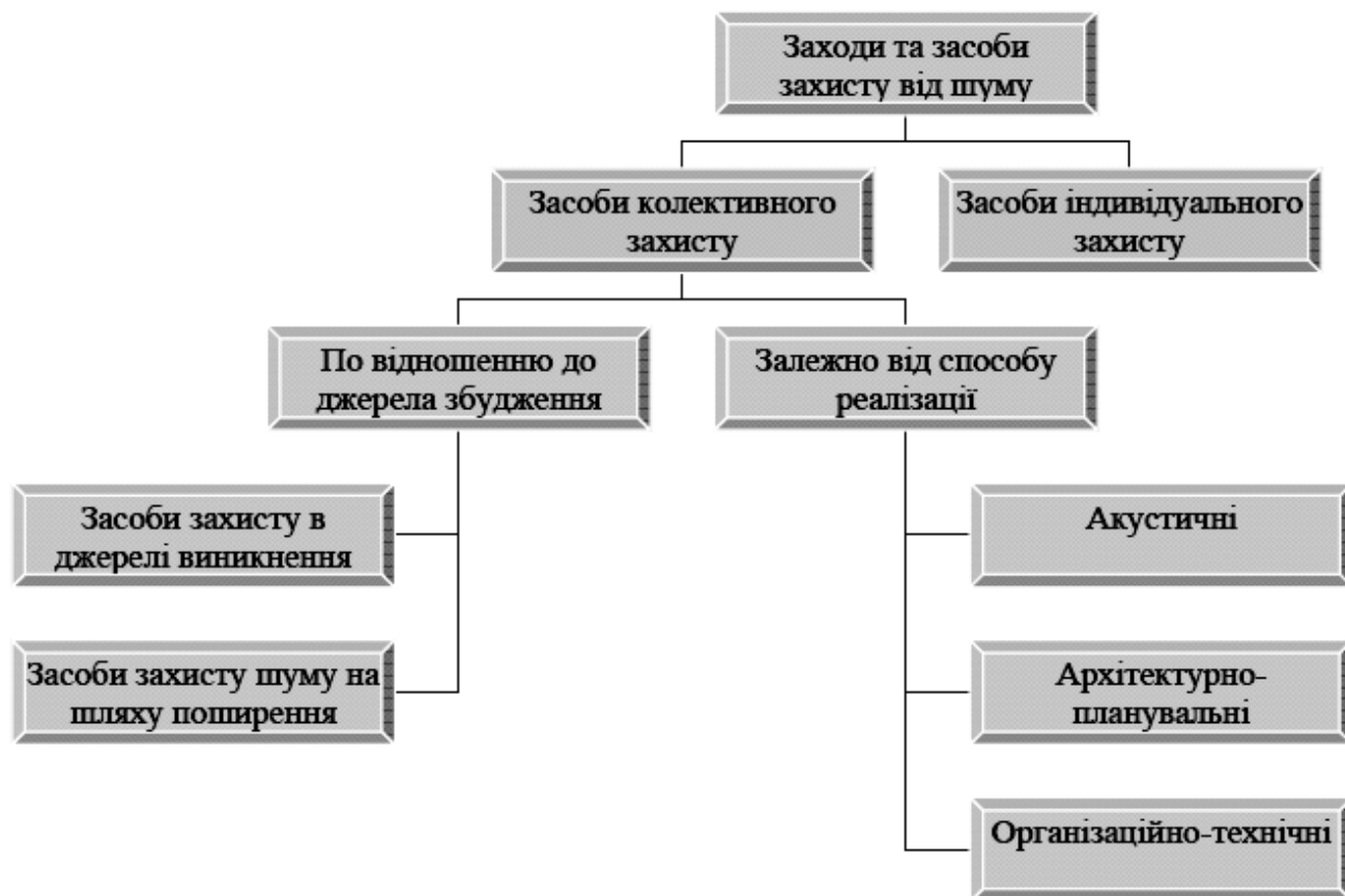
Рисунок 2.7 - Класифікація засобів та заходів захисту від шуму
