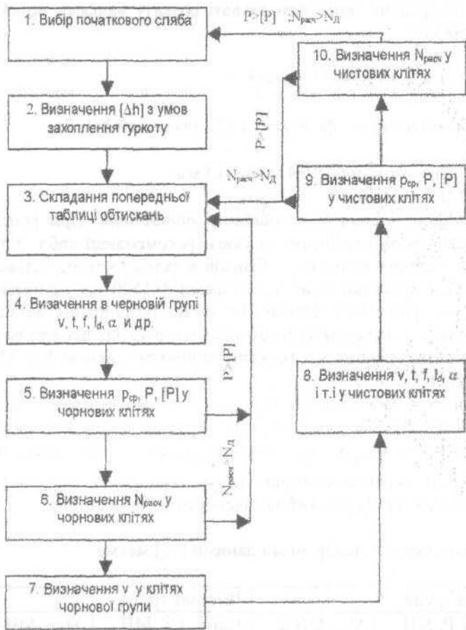
Рис. 3.20. Схема алгоритму розрахунку режиму деформації під час прокатки на ШСГП.
