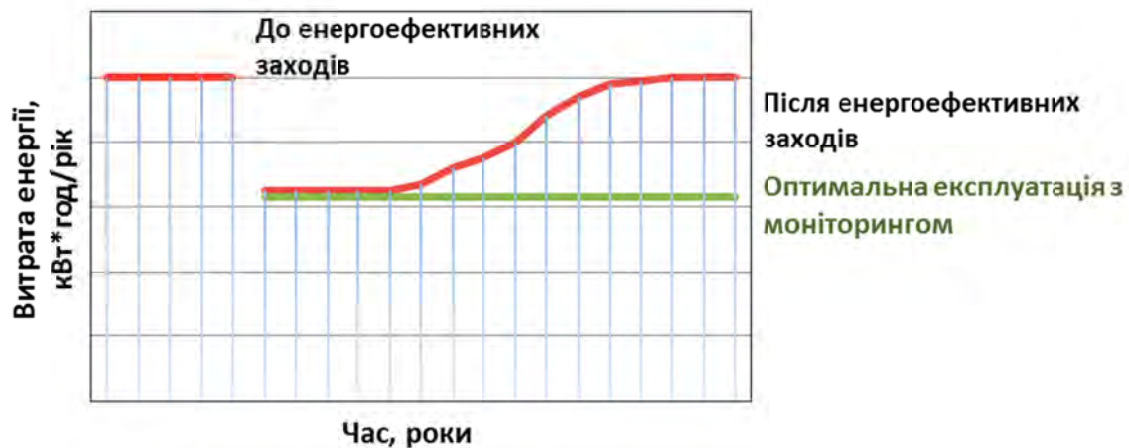
Рисунок 8.1. Графік енергоспоживання без та з застосуванням процедур моніторингу
