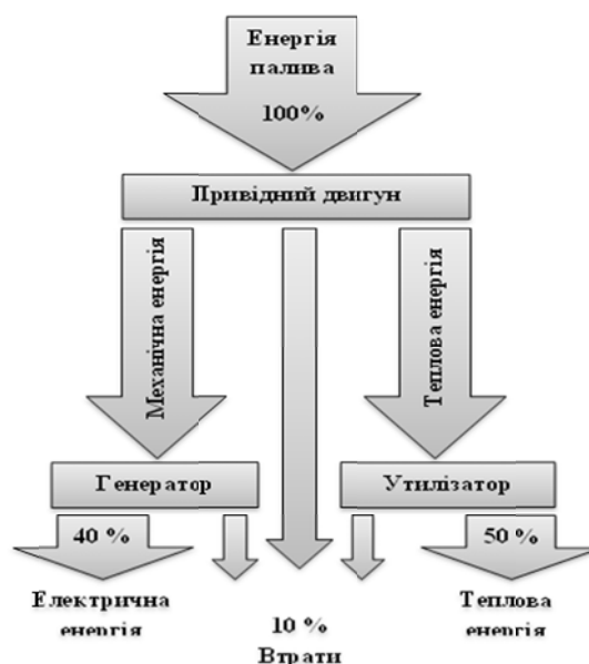
Рисунок 1. 1. Структурна схема когенераційної установки
