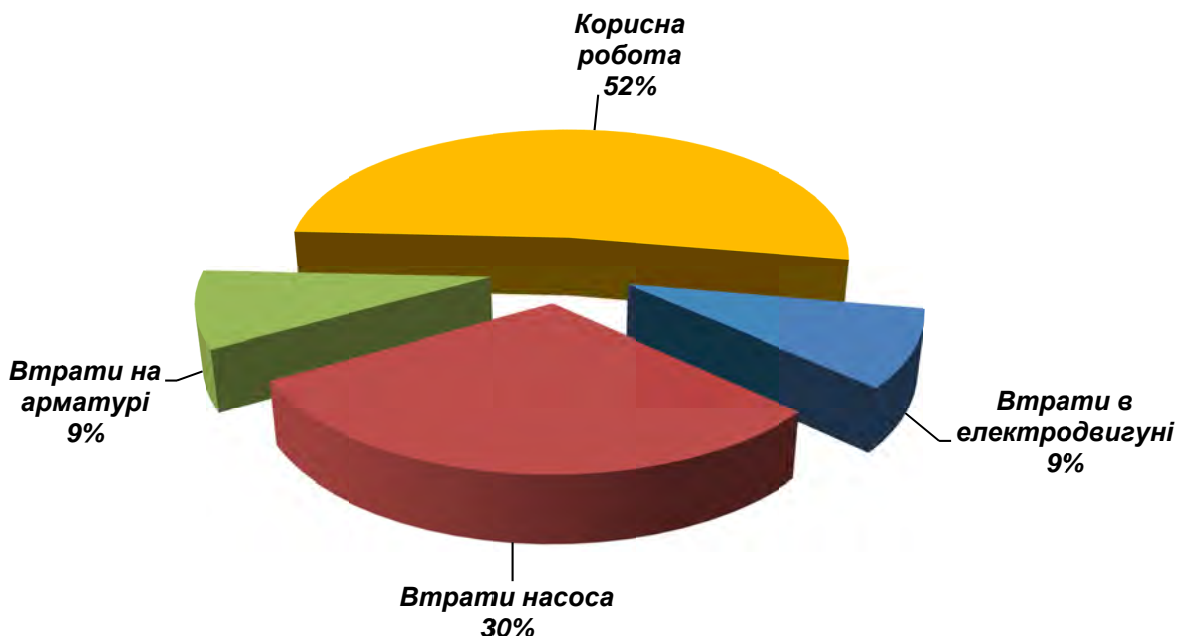
Рисунок 5.2. Приклад балансу використання електроенергії насосним агрегатом
