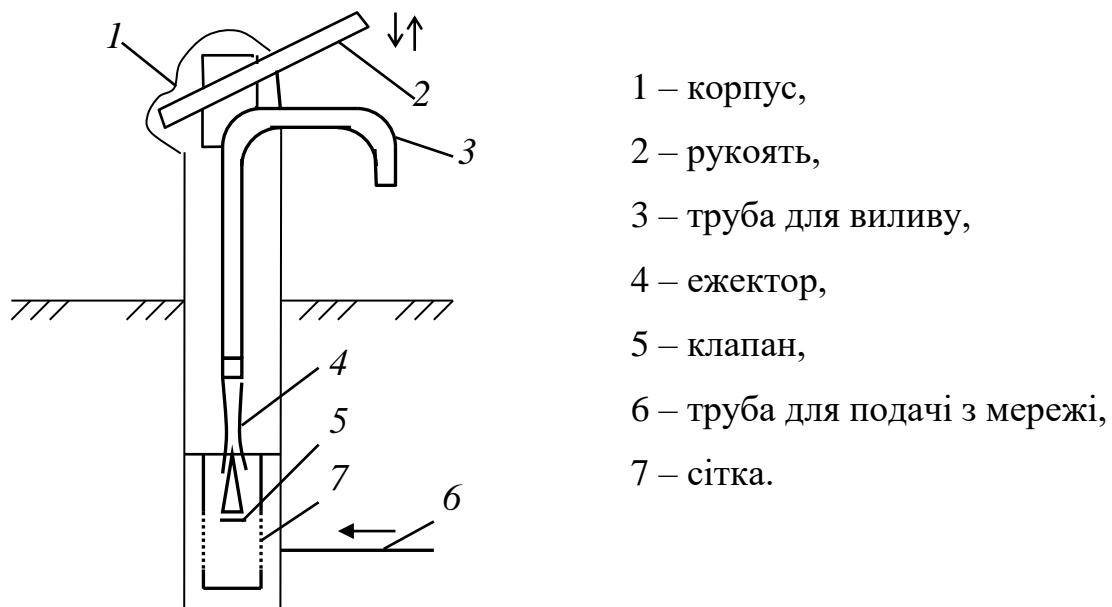
Рисунок 13.2 – Схема конструкції водорозбірної колонки
