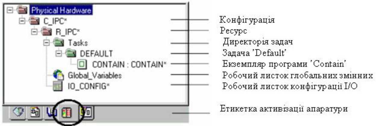
Рис. 2.6. Структура піддереву Physical Hardware
