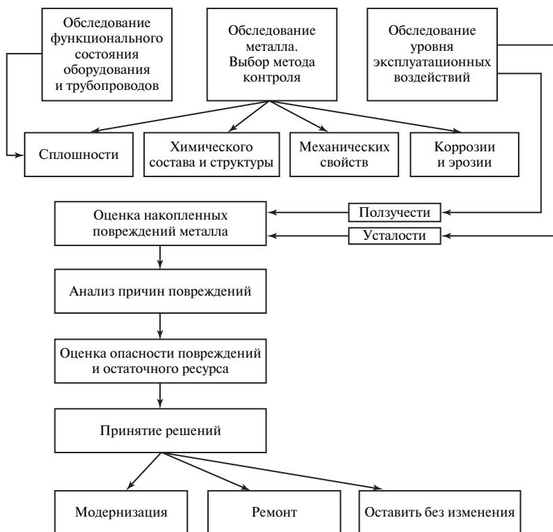
Рис. 14.4. Схема мероприятий при продлении ресурса эксплуатации оборудования и трубопроводов
