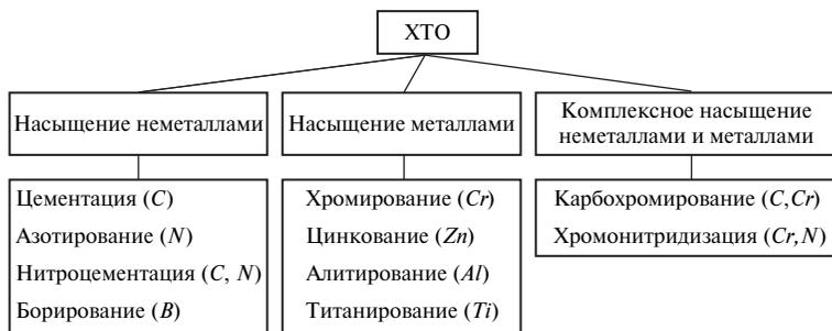
Рис. 7.16. Классификация способов ХТО в зависимости от насыщающих элементов
