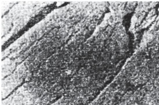
Рис. 5.7. Микрофрактограмма хрупкого излома металла (x500)
