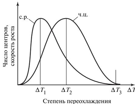
Рис. 2.13. Зависимости скорости роста кристаллов и числа центров кристаллизации от степени переохлаждения
