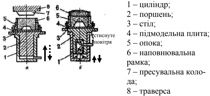
Рисунок 6 - Схеми способів ущільнення ливарних форм при машинному формуванні: а – пресуванням; б - струшуванням
