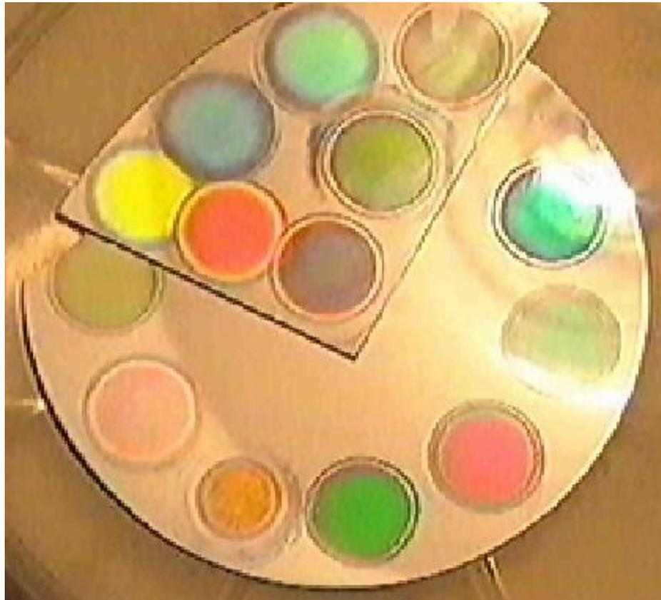
Эффективные оптические свойства слоев мезопористого кремния (цветные круглые области) определяются упорядоченной структурой пор и кремниевых нанокристаллов. В результате чего они значительно отличаются от свойств кристаллического кремния  $c\text{-Si}$ , из которого изготовлены.
