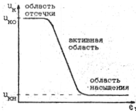
Рис. 2.2 Передаточная характеристика ключа
