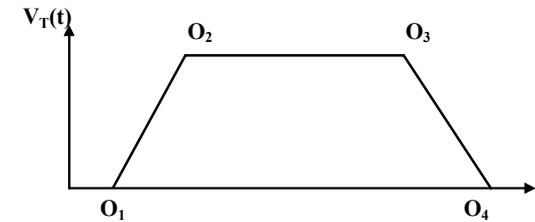
Рис. 5.5.  $O_1$  – точка начала разгона,  $O_2$  – точка конца разгона,  $O_3$  – точка начала торможения,  $O_4$  – точка конца торможения.
