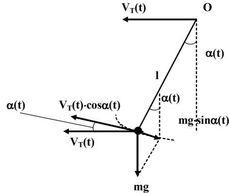
Рис. 5.4.  $V_T(t)$  - текущая скорость перемещения крана,  $\alpha(t)$  - текущий угол отклонения груза,  $m$  - масса груза.
