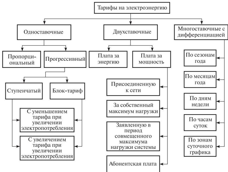
Рис. 3.6. Системы тарифов на электрическую энергию
