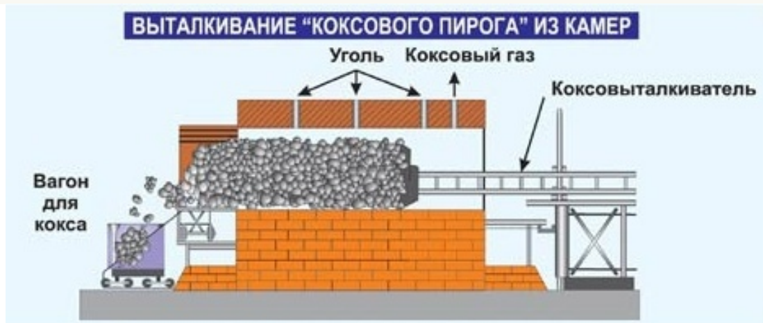
Рисунок - Схема выталкивания коксового пирога из коксовой печи
