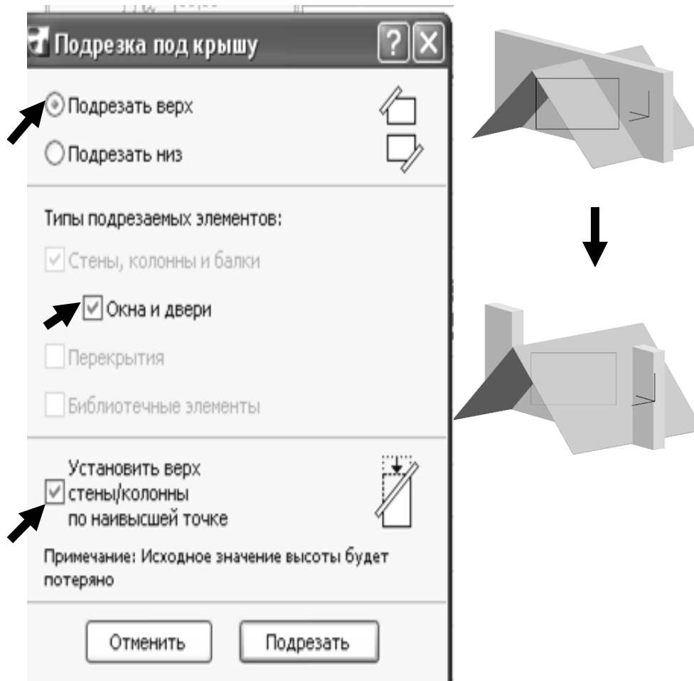
(Рис.5.5.4) – порезка стен под крыши
