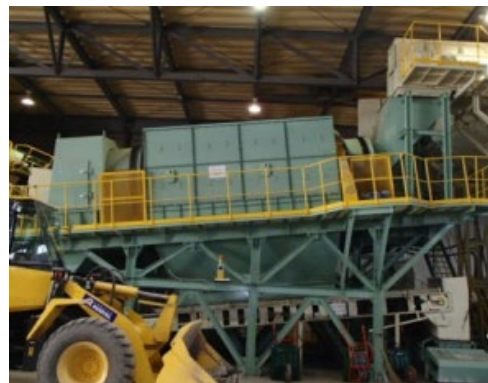
Барабанний просіювач
