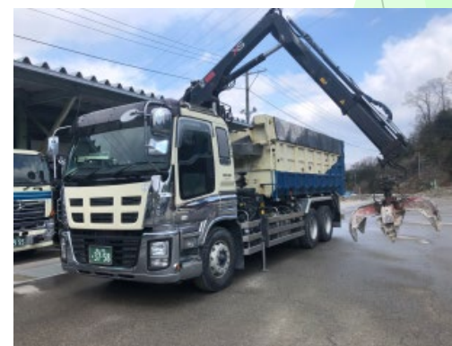
Вантажівка з краном-маніпулятором вантажопідйомністю 4 тони
