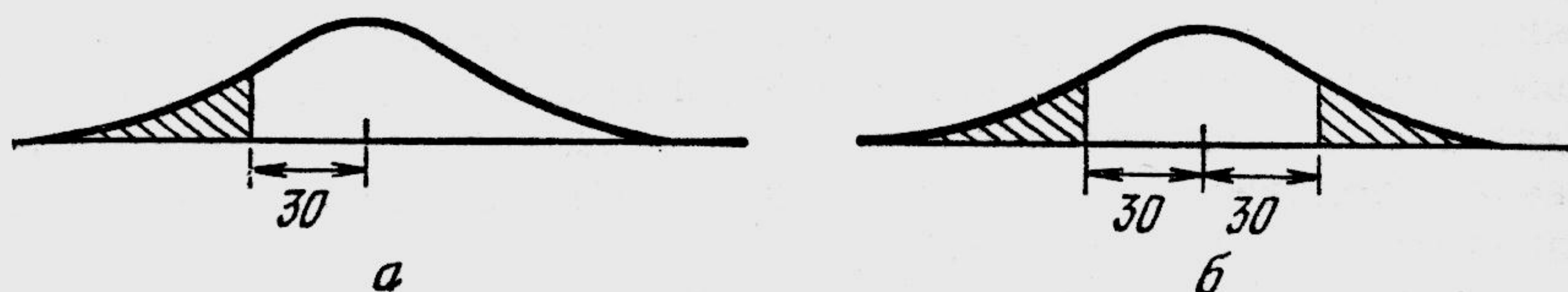
Рис. 10.6. а — «однохвостовая» вероятность получения результата, который более чем на 30 меньше среднего. б — «двуххвостовая» вероятность получения результата, который отличался бы на 30 и более в любую сторону. (Не в масштабе.)
