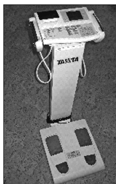
Рисунок 39 — Прилад “Tanita” (Японія) для визначення складу тіла
